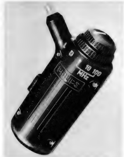
Bild 1. Philips-Störsuchgerät mit Transistorverstärker für die Autosuperwerkstatt
